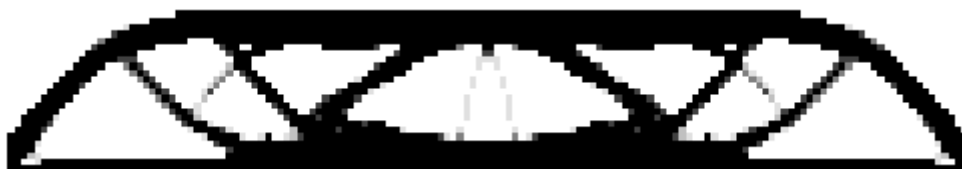
図12 MBB はりのトポロジー解析結果 ( w_g の変化に対して)
