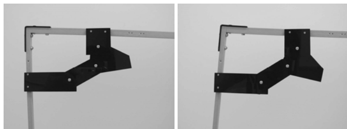
図 23 位相を参考に作成した模型と左右方向の変形 (Case B)
