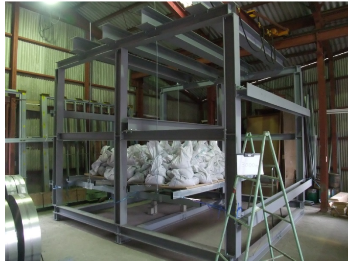
総積載荷重3トン載荷時 (3260N/m 2 )
