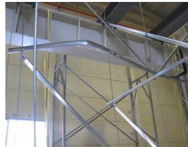
写真2 試験体2の損傷状況
