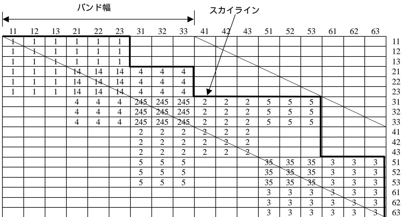
図 5.4 全体剛性マトリックスの成分とバンド幅およびスカイライン
