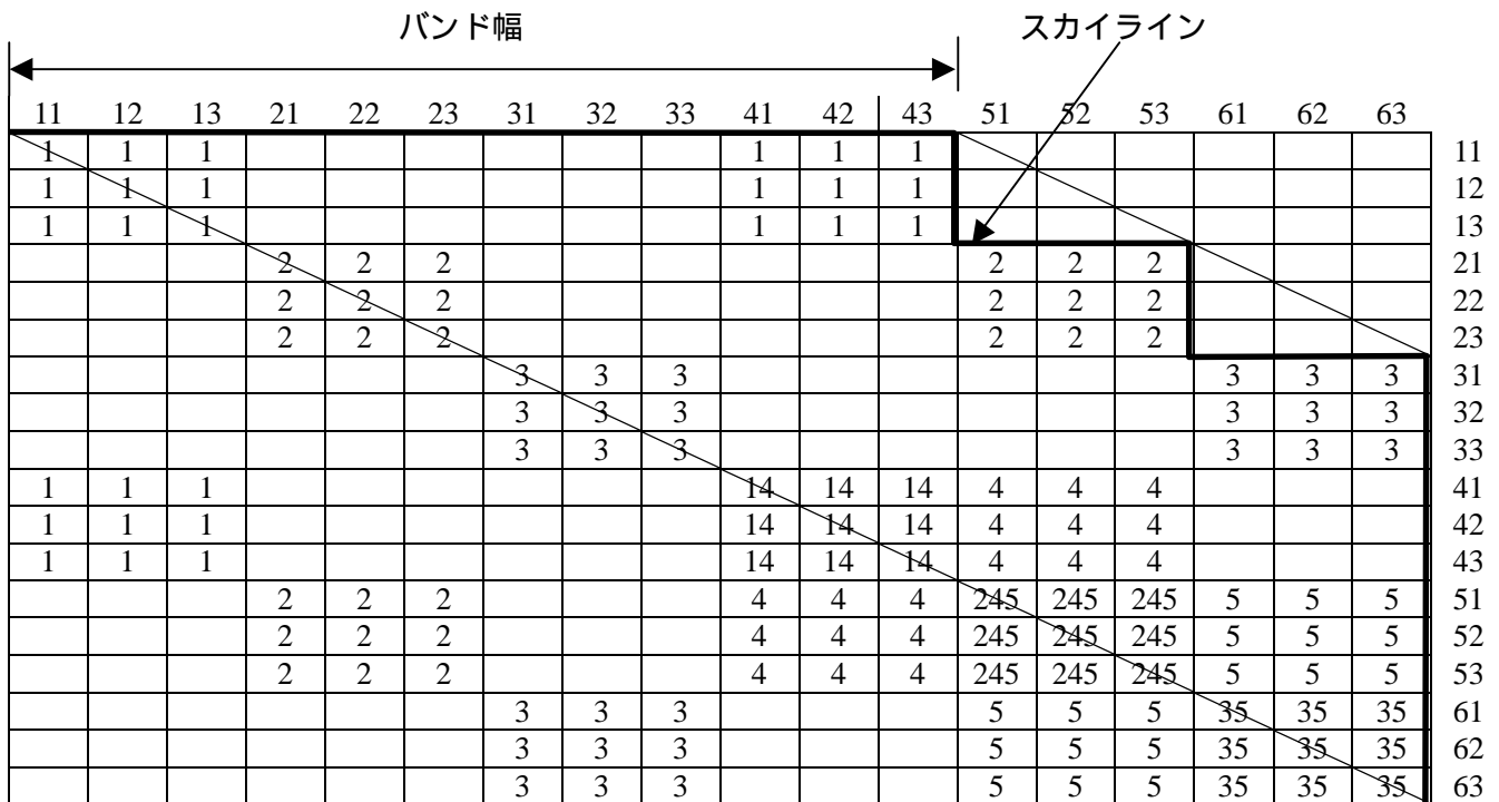
図 5.2 全体剛性マトリックスの成分とバンド幅およびスカイライン
