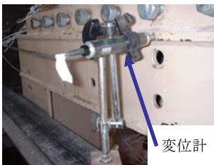
図 17 変位計設置風景
