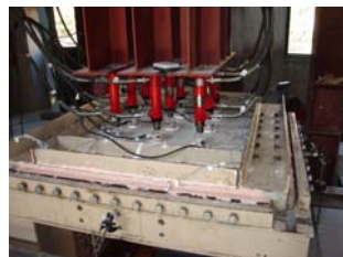
図 18 試験体上面 9 点載荷風景
