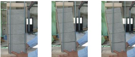
図 4 1P(モルタル)の場合の挙動
