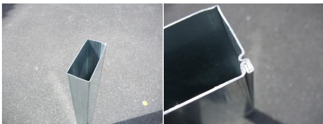
図 1 かしめ成形角形鋼管
