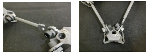
写真3 特殊立体金物の破壊形状
