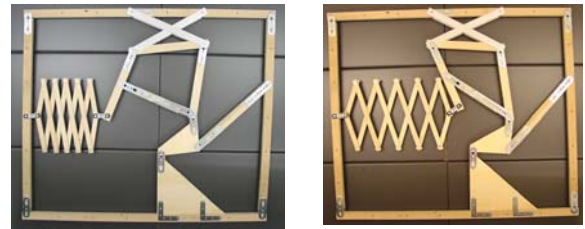
図 16 蛇腹ダンパーを用いた制震ユニット
