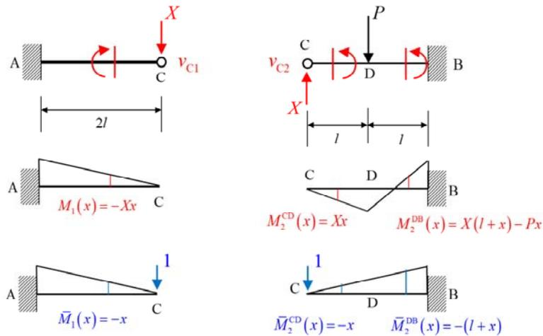
そこで、2つの梁のC点の鉛直変位を求めるために、それぞれの梁の曲げモーメント関数を求めます。
