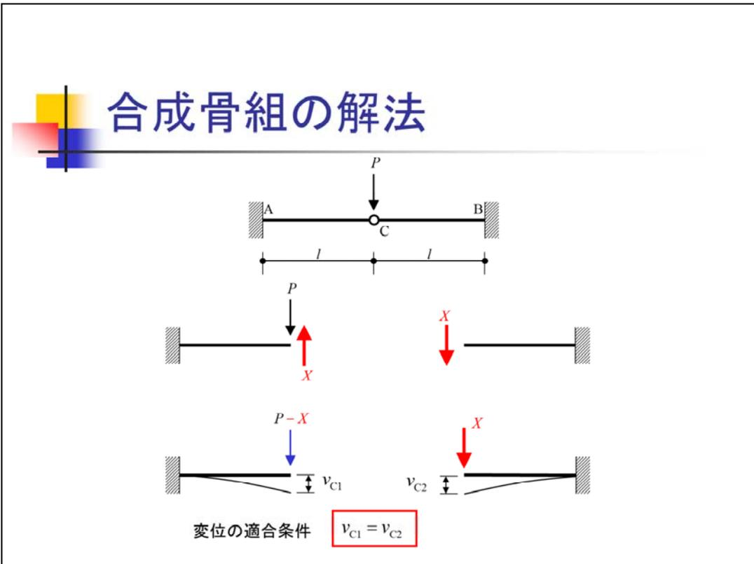
この問題を解くためには、前回と同様に、C点の鉛直変位の適合条件を用いて不静定力Xを求めます。
