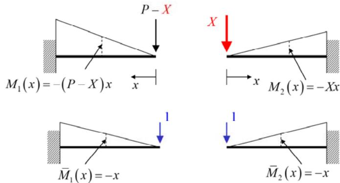
$$1 \cdot v_{C1} = \int_0^l \frac{\bar{M}_1(x) \cdot M_1(x)}{EI} dx$$
