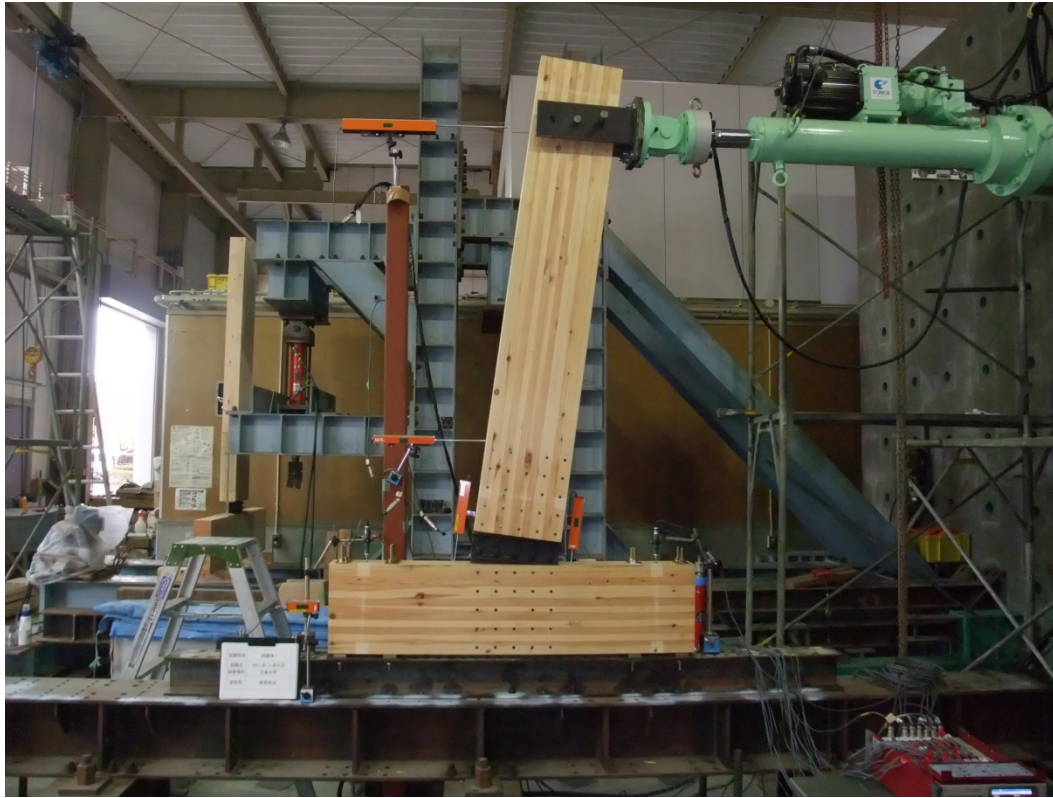
写真1 試験体A(FRP無補強仕様)の終局状況
