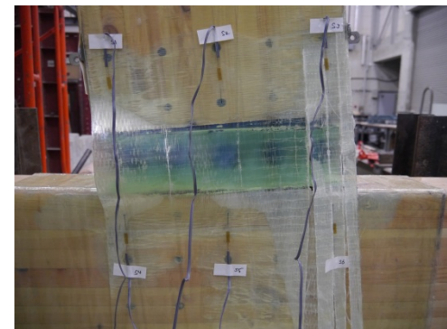
試験体4 (FRPあり)
