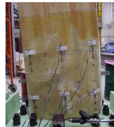
試験体2 (FRPあり)
