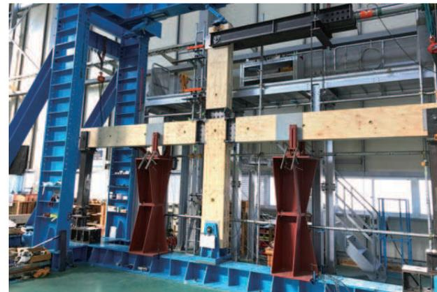
写真4 十字形要素試験体の設置状況
