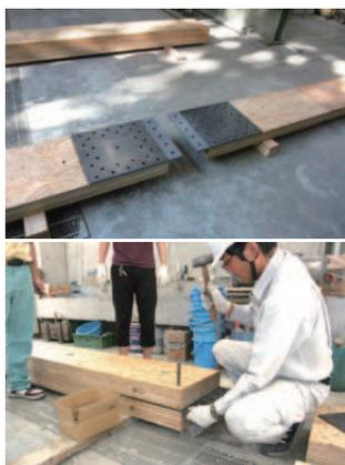
写真1 鋼板挿入型
