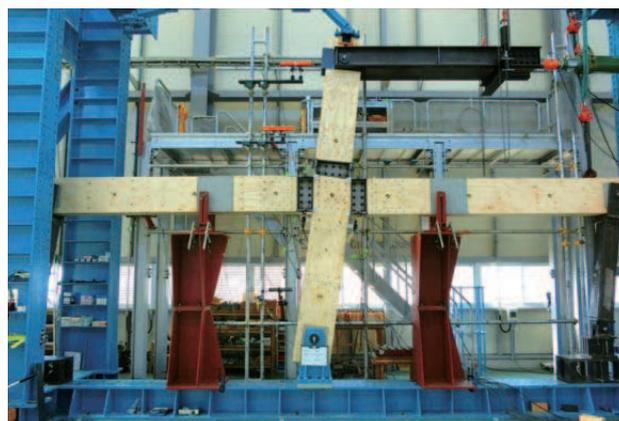
写真5 試験体の終局状況(全景)
