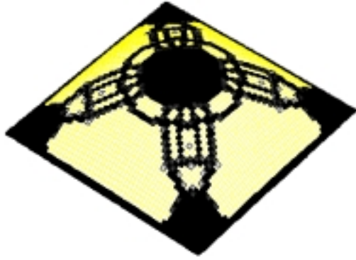
図6 シェル構造の位相最適化の結果(曲面形状は初期形状に固定)
