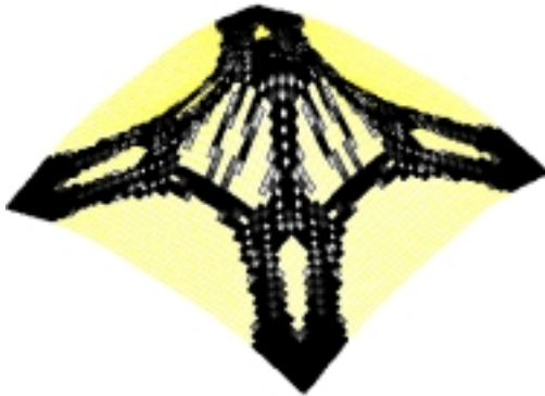
図7 シェル構造の位相最適化の結果(曲面形状も同時に最適化)
