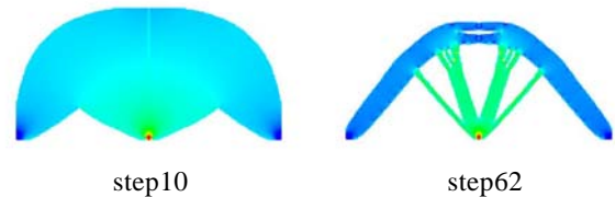
図 8 (a) P = 1000N での静水応力分布
