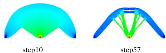
図 9 (b) P = 10MN での静水応力分布
