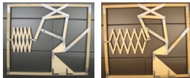
図-11 蛇腹ダンパーの設置
