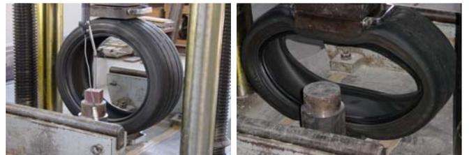
図-8 実物廃タイヤの実験の様子
