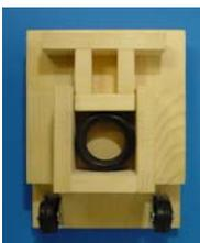
図-4 拘束有の実験装置とその骨組モデル
