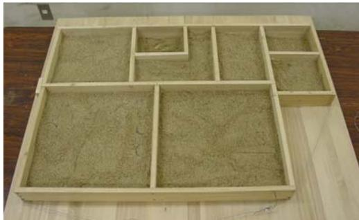
図-13 図-6 模型を砂で埋めた基礎伏せ 1/10 模型
